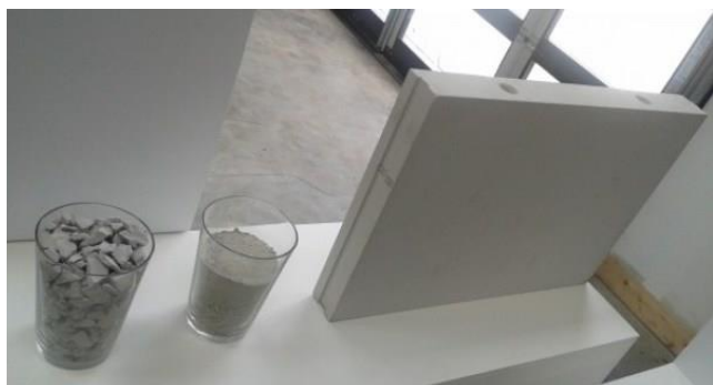
Figuur 24: Gebruik van kalkzandsteenpuin voor nieuwe kalkzandsteen elementen Caldubo® (bron: Calduran)
