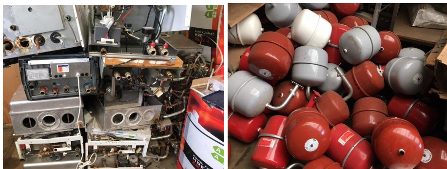
Figuur 35: Hergebruik onderdelen CV-ketel (bron: CV ketel recycling)
