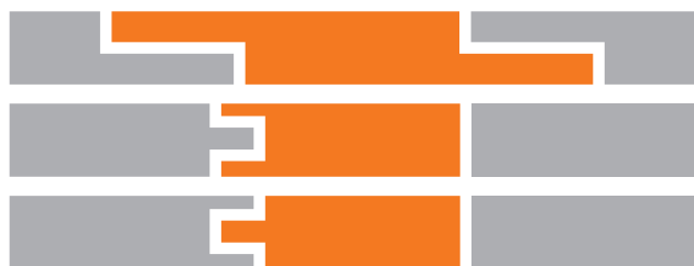
Figuur 10: Overlapping, gedeeltelijke belemmering voor het (tussentijds) uitnemen van producten of elementen.
