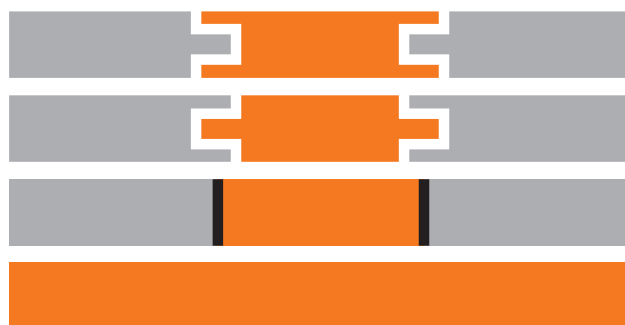
Figuur 11: Gesloten, volledige belemmering voor het (tussentijds) uitnemen van producten of elementen.
