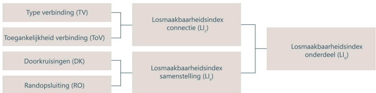
Afbeelding 4.2 Factoren voor het bepalen van de losmaakbaarheidsindex van een element of product
