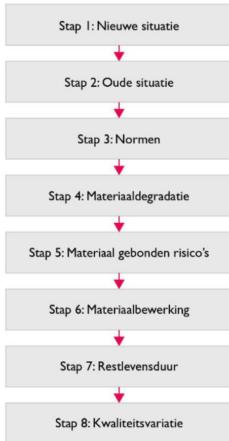
Figuur 3 – Stappen voor de technische beoordeling van hergebruiksmogelijkheden van producten (SGS INTRON, 2021), gebaseerd op de beslisboom hergebruik
